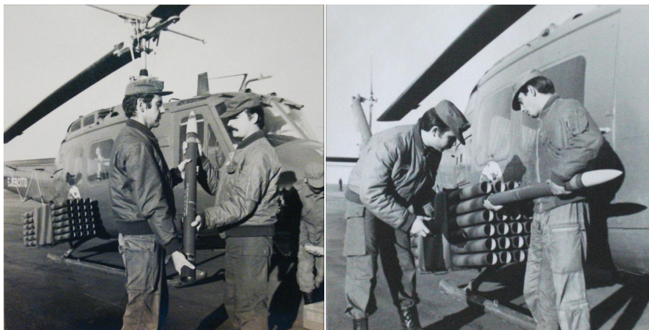
Aeródromo militar Campo de Mayo. Cargando el lanzador de un Bell UH-1H con cohetes de 70 mm Albatros . 28 de mayo de 1975
